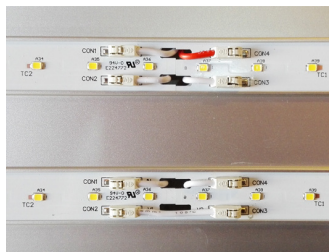
Moduli LED sostituibili
