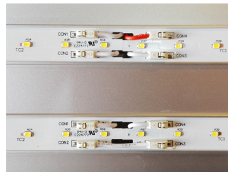
Moduli LED sostituibili
